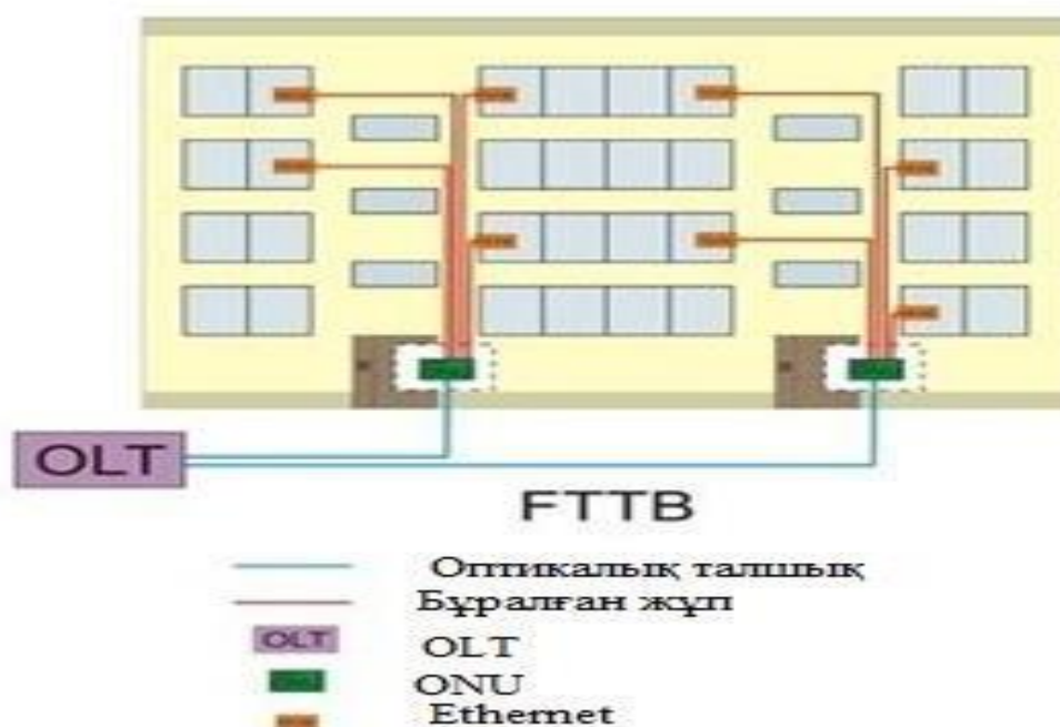
2.4-сурет-көп пәтерлі ғимараттағы FTTB желісінің құрылымы
